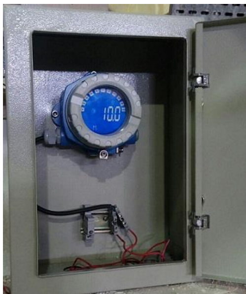
شکل ۵) نشان دهنده‌ی RIA14 از شرکت Endress & Hauser
